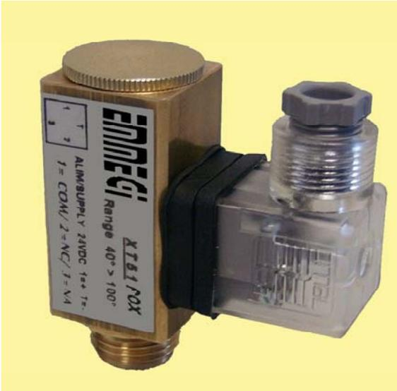
I termostati serie XT 51 in scambio permettono la commutazione di un contatto elettrico al raggiungimento di un valore temperatura predefinito. La regolazione avviene tramite un trimmer posizionato sulla scala graduata sotto il coperchio a tenuta.
